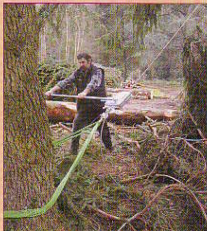
1 Per la trazione della pianta, che simula l'azione del vento, viene impiegato un paranco manuale.
